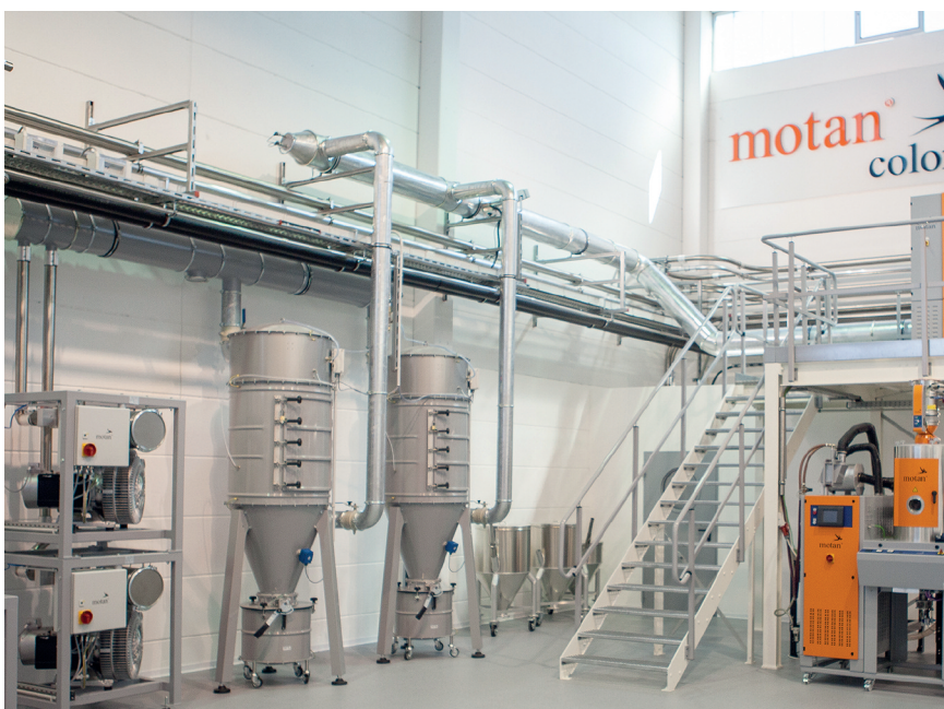
Beispiel für ein permanentes Zentralvakuum, installiert im Tech Center von Motan-Colortronic in Friedrichsdorf: in der Bildmitte zwei Zentralfilter, links zwei übereinander angeordnete Seitenkanalverdichter (Bilder: Motan-Colortronic)
