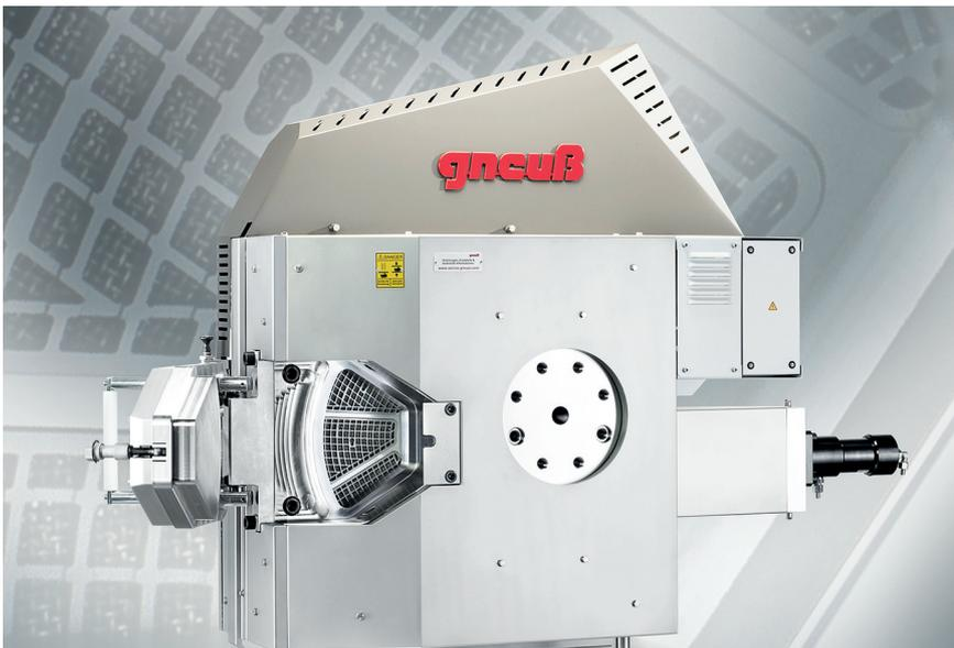
Der MRS-Extruder, ein Einschneckenextruder mit einer innovativen Multiwellen-Entgasungszone, ermöglicht eine äußerst effiziente Entgasung der Kunststoffschmelze. Durch die Prozessdynamik der gegenlaufenden Satellitenschnecken im Multi-Rotationsbereich wird die Polymeroberfläche ständig erneuert und damit der Diffusionsprozess drastisch verbessert. Daher ist das System hervorragend geeignet für die Verarbeitung von stark kontaminierten Kunststoffen.
