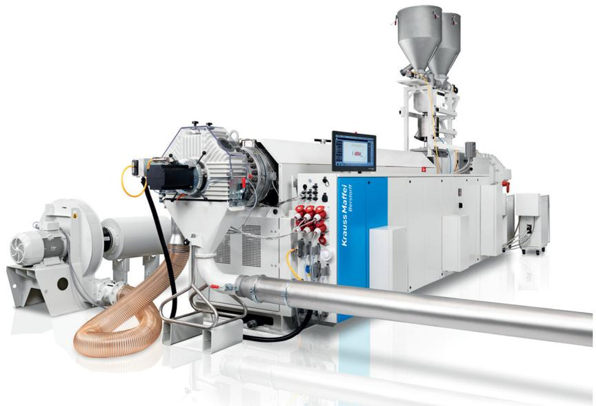
**Doppelschneckenextruder der 32D Baureihe mit Granulierkopf**
