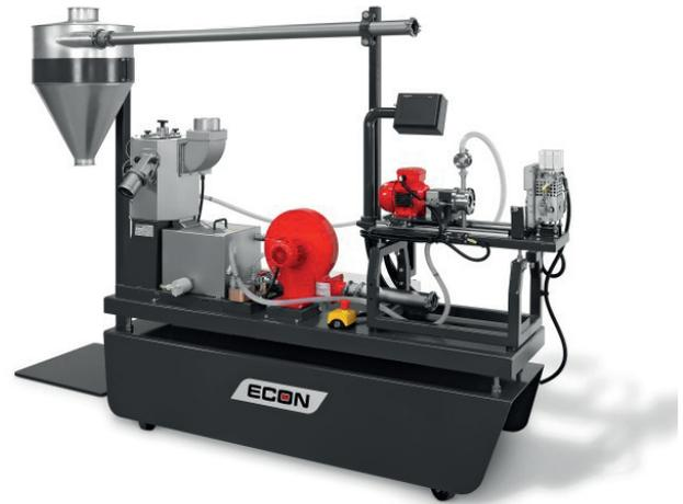
Die erfolgreiche Entwicklung von neuen, anforderungsgerechten Produkten und das schnelle Übertragen der Entwicklungsergebnisse in die Produktion beschäftigen heute nahezu alle innovativen Materialhersteller. ECON-Granulierungssysteme unterstützen deswegen diese Hersteller mit Up-Scale-fähigen Maschinen in Durchsatzgrößen von 1 bis 10.000 kg/h.
