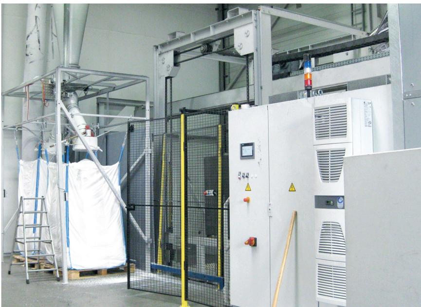
*Alles automatisch: Für einen namhaften deutschen Plattenextrudierer realisierte Getecha eine zerkleinerungstechnische Komplettlösung inklusive Zuführtechnik mit Hebe- und Fördersystemen, RotoSchneider-Zentralmühle, Verpackungstechnik für das Mahlgut und Steuerungstechnik (Bild: Stöcker)*
