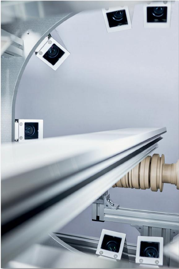
*Durchbruch dank neuer Kamertechnologie: PC7 DualVision XXL lässt sich elektronisch kalibrieren und braucht deshalb keinen mechanischen Antrieb mehr*
