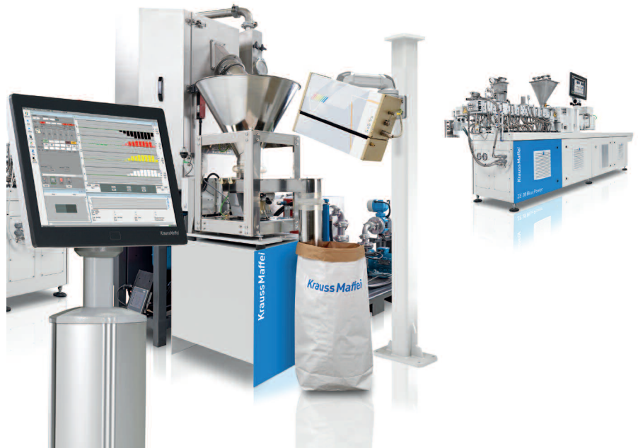
Das innovative System ColorAdjust kombiniert ein Farbmessgerät mit Fotospektromerertechnologie und Maschinensteuerung und sorgt somit für präzise, reproduzierbare Farben (Fotos: KraussMaffei)
