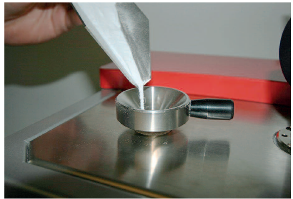
Für eine MVR Messung wird Polyamid 12 Pulver in den Prüfkanal gefüllt (Bildquelle: ZwickRoell)
