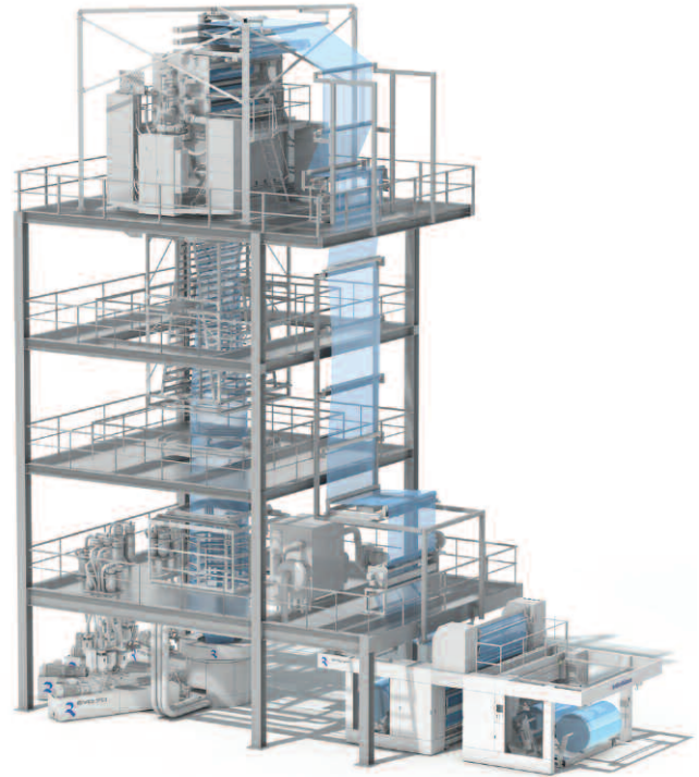
Reifenhäuser EVO Ultra Stretch: Die Position der Reckeinheit direkt im Abzug der Blasfolienanlage ist patentiert und ein Alleinstellungsmerkmal im Markt
