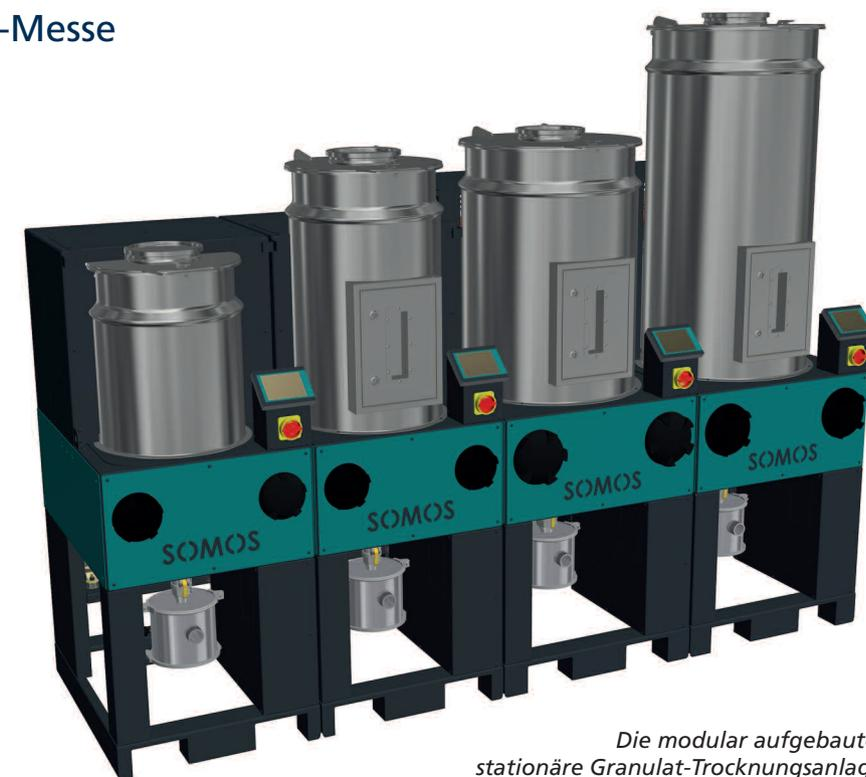
Die modular aufgebaute, stationäre Granulat-Trocknungsanlage SOMOS RDF (Resin Dryer Flexible) lässt sich entsprechend des benötigten Durchsatzes aus mehreren, unabhängig voneinander arbeitenden Trocknungsmodulen zusammensetzen. Abgebildet ist eine Anlage aus vier Komponenten (Bilder: ProTec Polymer Processing)
