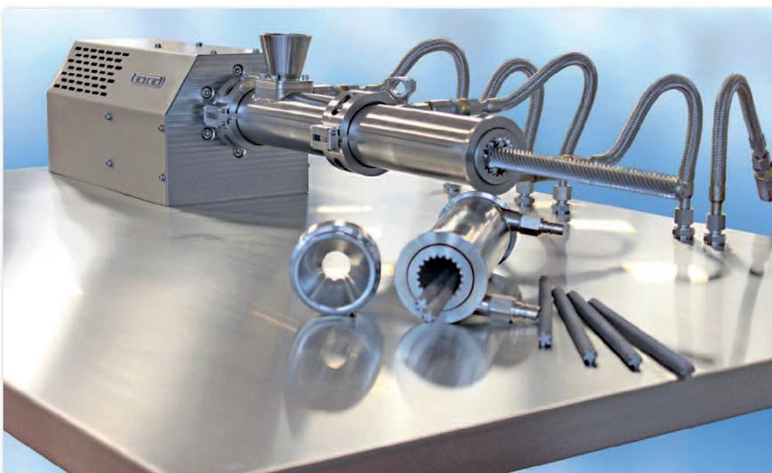
Mit dem neuen L-WE können nun die Vorteile des Planetwalzenextruders – absolute Temperaturkontrolle und wirkstoffgerechtes Mischen, scherarme Dünnschichtauswalzung, großer Oberflächenaustausch – auch in materialkritischen Bereichen Anwendung finden. ENTEX bewegt sich damit nun auch in Materialmengen von mehreren hundert Gramm pro Stunde.
