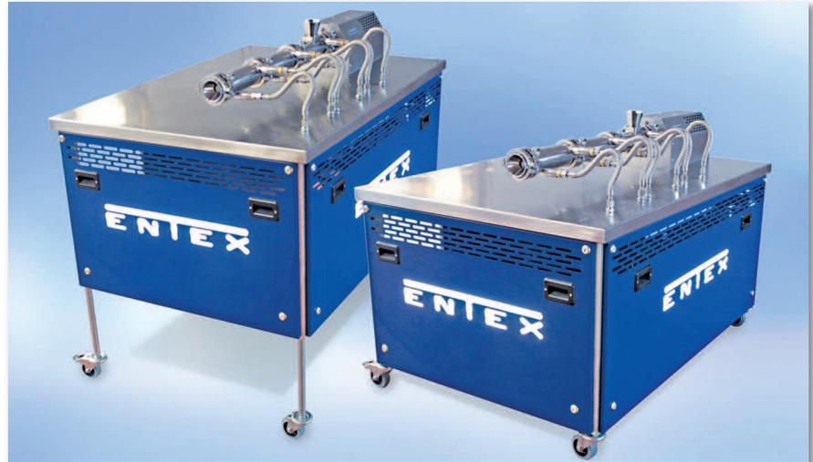
*Das Messe-Exponat, der Laborwalzenextruder L-WE 30: Die Höhe des großzügig gestalteten Unterbaus lässt sich per Knopfdruck auf die örtlichen Gegebenheiten anpassen. Um für die Temperierung eine hohe Effektivität und sehr kurze Reaktionszeiten zu erreichen, lassen sich Wärmetauscher in den Unterbau integrieren, die mit Primärenergie, zum Beispiel mit vorgeheiztem Wasser, versorgt werden können. Die Durchsatzleistung liegt abhängig von Fördergut und Prozessparametern bei circa 1 bis 10 kg/h*
