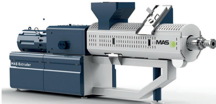
**Bild 1:** Die konischen Gleichlauf-Doppelschneckenextruder sind in sechs Größenstufen mit einer Durchsatzleistung von 10 bis über 2.000 kg/h verfügbar (Alle Bilder: MAS)
