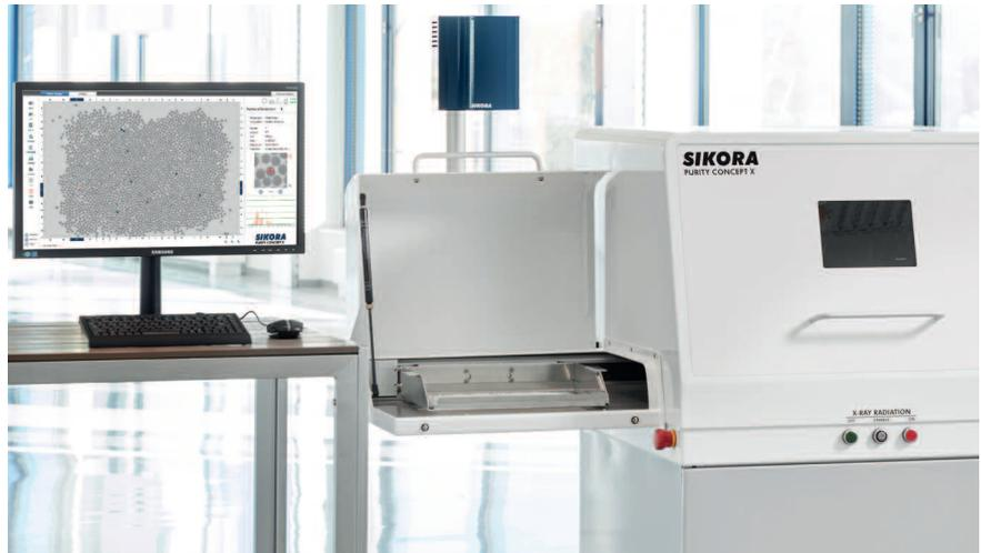
Das auf Röntgen basierte PURITY CONCEPT X detektiert offline unter anderem metallische Kontaminationen im Granulat
