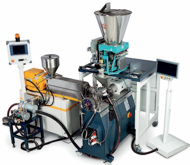
**Bild 2:** MAS-Hochqualitäts-Compoundierkonzept als Kombination aus konischem Gleichlauf-Doppelschneckenextruder als Additiv-Förderer und Einschnecken-Sidefeeder zur Polymerzugabe
