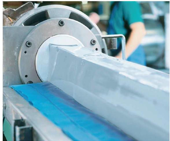
Siliconelastomere haben generell den Vorteil, dass sie schwer brennbar sind und im Brandfall wenig Rauch produzieren. Außerdem sind Silicone halogenfrei. Bei einem Brand bildet sich also kein Chlorwasserstoff, weshalb der Rauch von Siliconen deutlich weniger toxische Substanzen aufweist als dies bei anderen Materialien der Fall ist. Diese Eigenschaft – Fachleute sprechen von der Rauchgas-toxizität – gewinnt zunehmend an Bedeutung. Silicone bietet hier eine sehr hohe Sicherheit.
