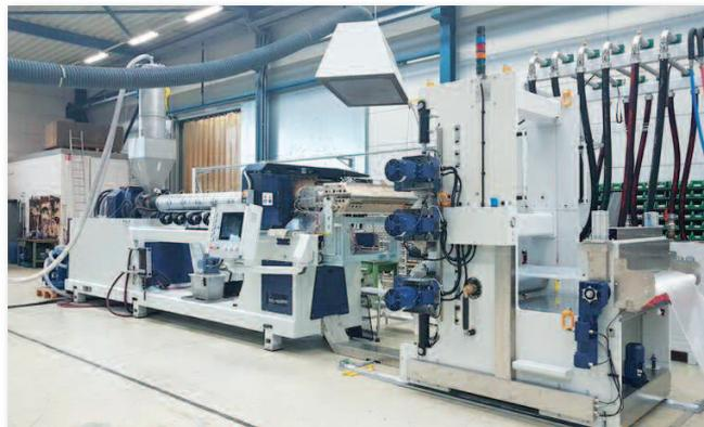
*EconCore hat sich zur Probefertigung seiner ThermHex Wabenkern-Sandwichplatten aus recyceltem Polyethylenterephthalat (R-PET) für den schnellaufenden und energieeffizienten MEAF 50-H34 Extruder entschieden (Quelle: MEAF)*
