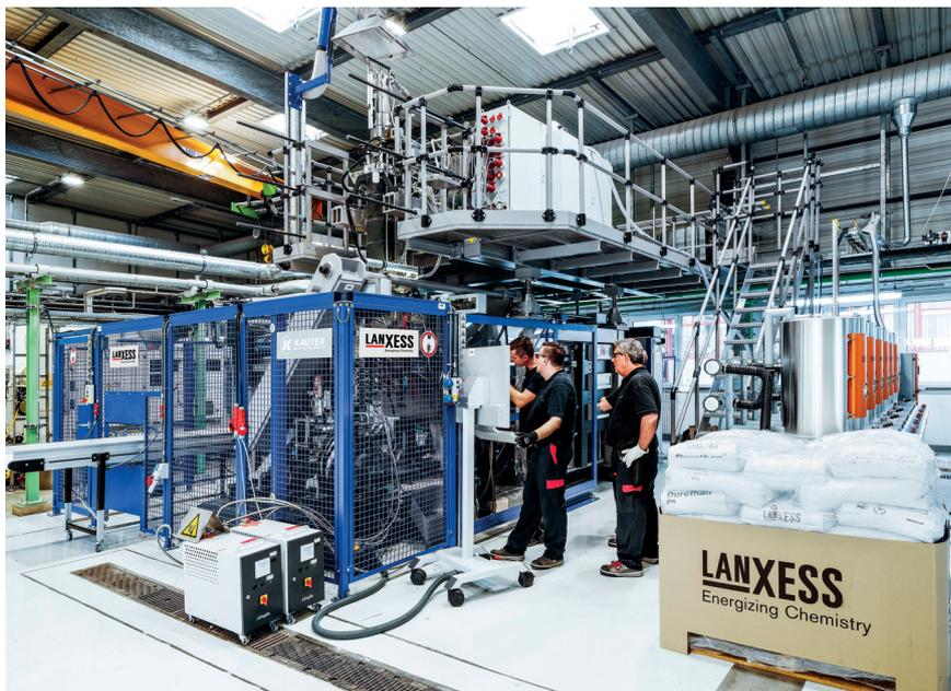
Bei der neuen Anlage handelt es sich um eine Extrusionsblasformmaschine vom Typ KBS20-SB der Kautex Maschinenbau GmbH aus Bonn (Foto: LANXESS AG)
