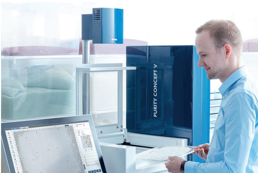
Das PURITY CONCEPT V wird zur optischen Stichprobeninspektion von Kunststoffgranulat eingesetzt. Detektiert werden unter anderem Black Specks
