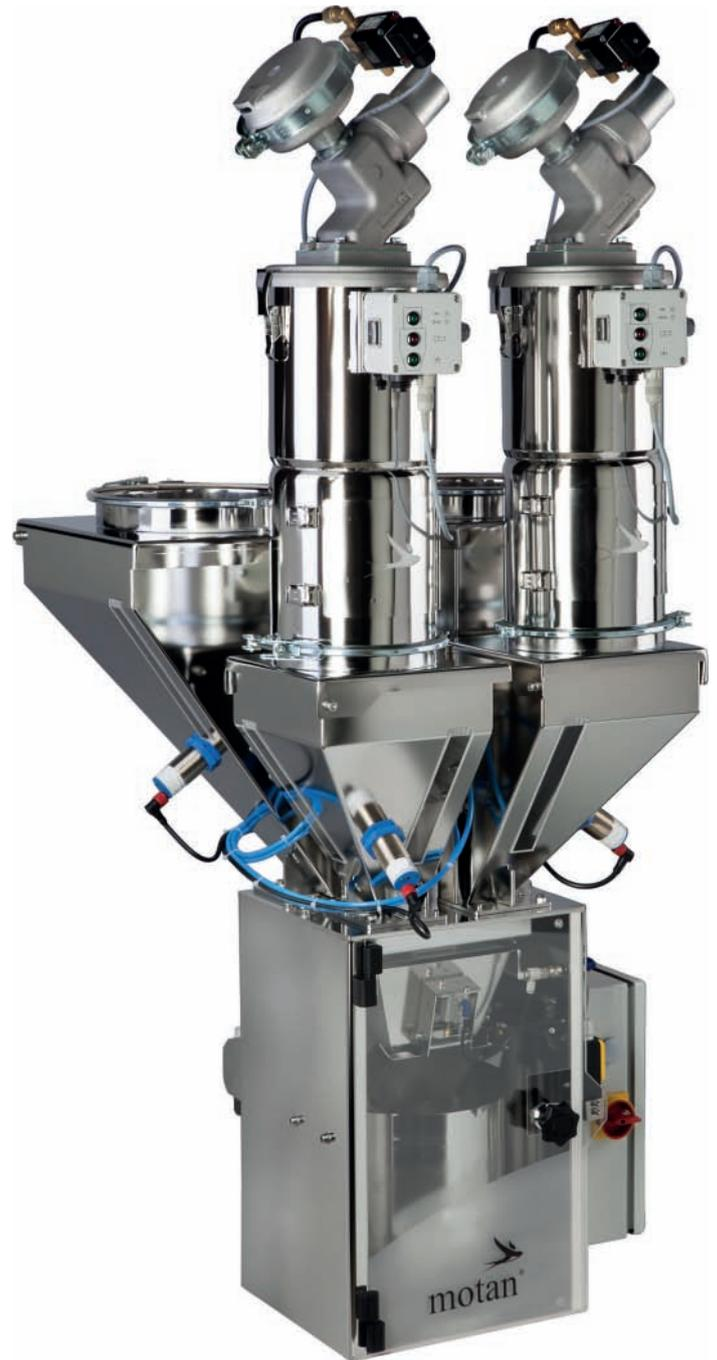
*Um eine Kontamination der Produktionsumgebung zu verhindern, ist das aus elektropolierem Edelstahl gefertigte gravimetrische Dosier- und Mischsystem Ultrablend mit einem Membranventil (oben) ausgerüstet. Betrieben wird das Ventil über die Vakuumleitung und nicht mit Druckluft*
