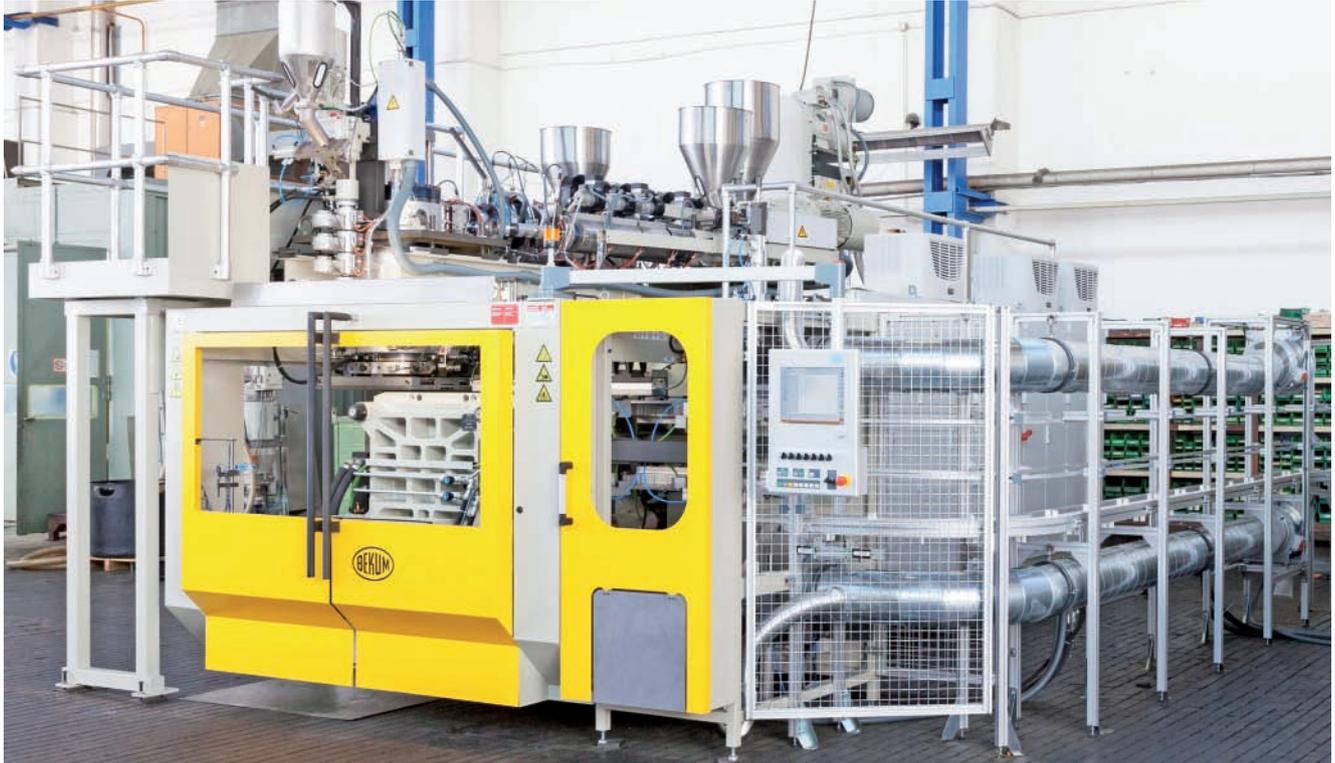
Neue elektrische EBLow 37 mit einer Schließkraft von 370 kN und einer Formbreite von 700 mm
