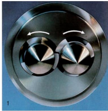
Bild 5.1): Gegenläufer kämmend
