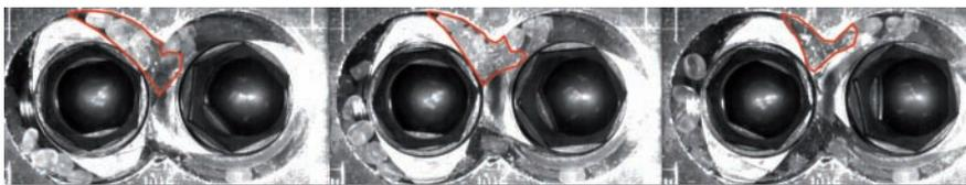
wird das Granulat verdichtet und in das freie Volumen gepresst. Anschließend wird in dieses vorkompaktierte Volumen massiv Energie durch weitere plastische Deformation eingebracht.
