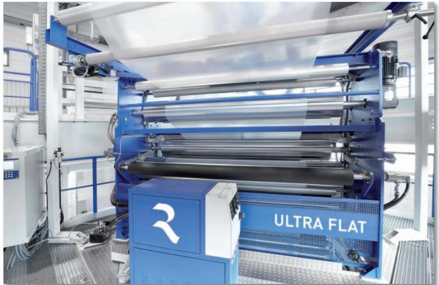
Für die Produktion von Laminierfolien mit hervorragenden Planlageeigenschaften hat sich das EVOLUTION Ultra Flat bereits etabliert
