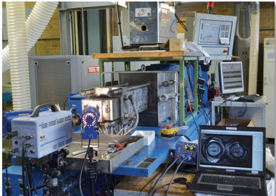
*Versuchsaufbau zur Visualisierung der plastischen Deformation von Kunststoffgranulat (Fotos: Fraunhofer LBF)*
