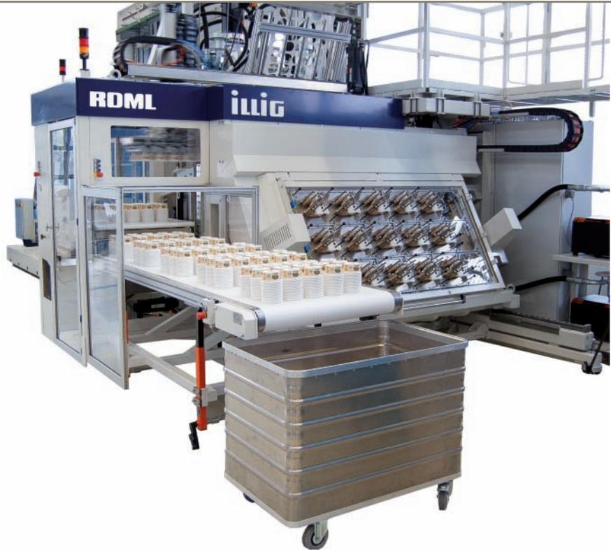
*IML-T zur markenwirksamen Dekoration mit hoher Regalwirkung: Auf der K 2016 entstehen mit dem Formautomat ILLIG IC-RDML 70 und einem 18-fach-Werkzeug in einem Arbeitsgang brillant dekorierte Verpackungen aus PP (Bilder: ILLIG)*
