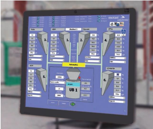
Mit seiner grafischen Bedienoberfläche unterstützt das Anlagen-Informationssystem Linknet das Personal beim Bedienen und Überwachen der Anlage indem es alle wichtigen Parameter transparent darstellt. Über eine Schnittstelle lassen sich die protokollierten und archivierten Daten weiterverarbeiten
