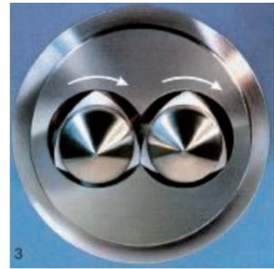
Bild 5.3): Gleichläufer
