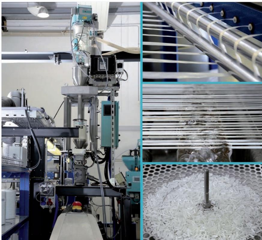
Mit der LFT-Anlagentechnik von ProTec entstehen durch Pultrusion hochwertige langfaserverstärkte Granulate mit vielfältiger Polymermatrix und unterschiedlicher Faserverstärkung (Bilder: ProTec Polymer Processing)
