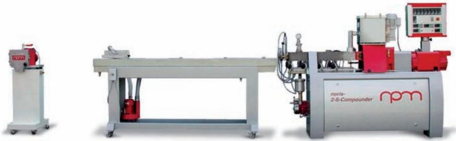
**Bild 2: LAB Stranggranulier-Anlage**
