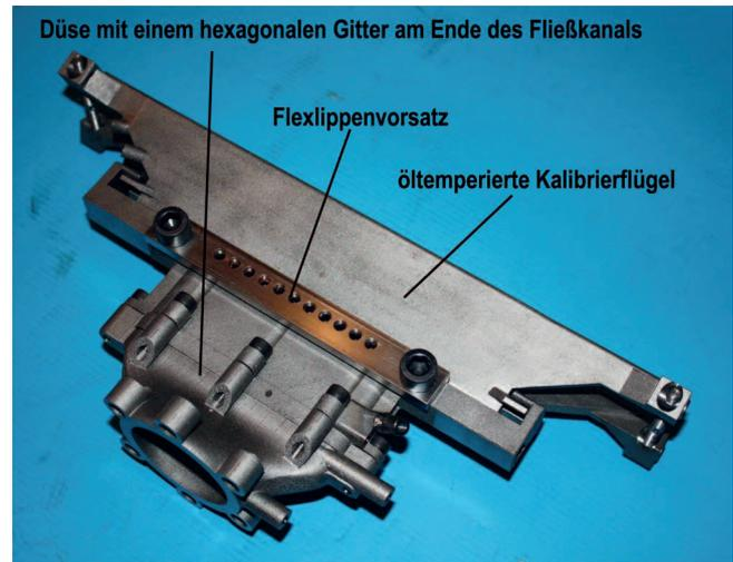
*Bild 3: Dreigeteilte Düseneinheit, die speziell zu Forschungszwecken konzipiert wurde*
