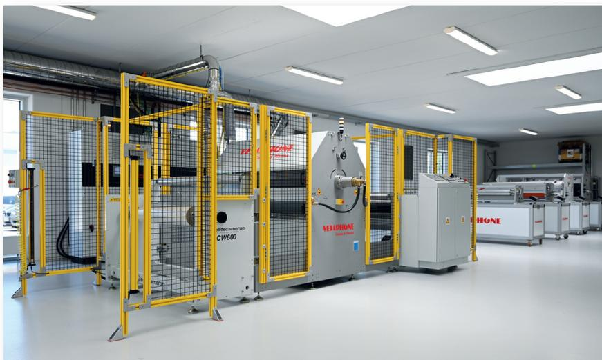
*Die neue Hightech-Laboranlage in Dänemark bietet Korona- und Plasma-Vorbehandlung für Rolle-zu-Rolle-Tests von Substraten zur genauen Simulation einer kommerziellen Produktion*
