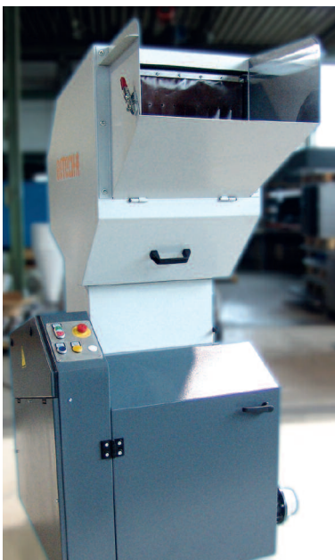
Ausgelegt für Stundendurchsätze von bis zu 160 kg ist die RS 2404 B von Getecha. Als Mittelklasse-Trichtermühle findet sie sich in vielen Blasformbetrieben
