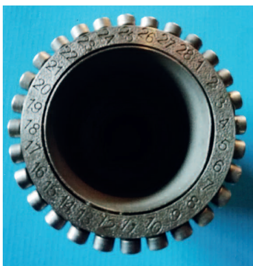
Bild 6: Flexringdüse (Durchmesser 50 mm) mit 28 Stellschrauben, bei der der flexible Ring mit Hilfe der Schraube Nr. 5 lokal begrenzt verformt worden
