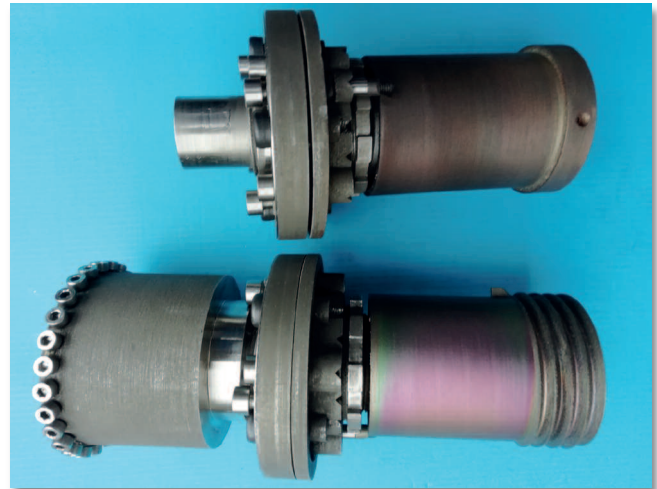
Bild 1: Foto von zwei generativ hergestellten Köpfen für zwei Kunden, die entsprechend der unterschiedlichen Anforderungen des jeweiligen Kunden konzipiert worden sind
