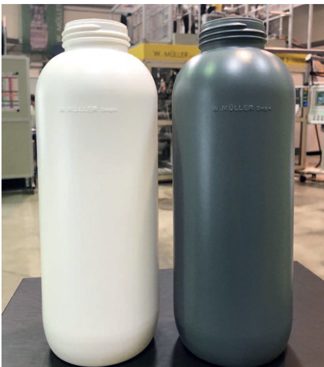
Für die Versuchsreihe wurden Flaschen aus reinem PCR hergestellt (rechts), sowie mit dem ReCo 3 -Verfahren Flaschen, die innen und außen eine Schicht aus Neuware aufwiesen
