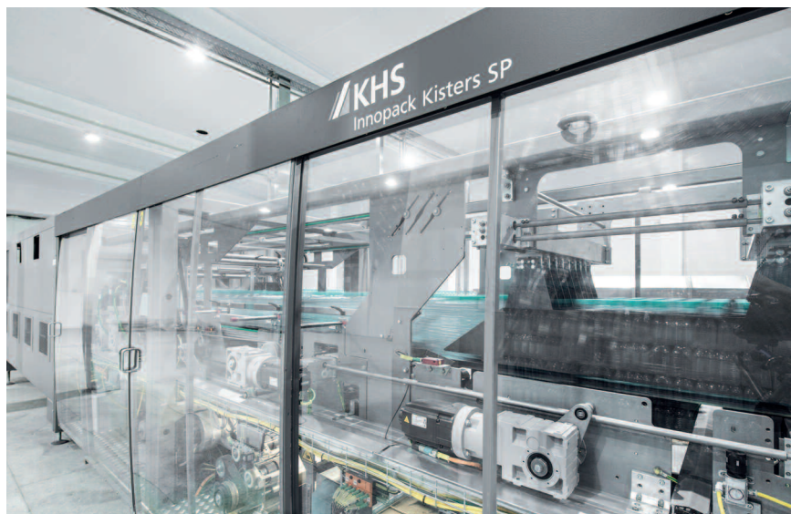
Der Einsatz von Folien aus recyceltem Material ist ab sofort auf allen KHS-Schrumpfpackern möglich, darunter auf dem flexibel einsetzbaren Innopack Kisters SP. Die vollautomatische Verpackungsmaschine bedient ein breites Produktspektrum und sorgt für maximale Stabilität der Gebinde (Alle Bilder: Quelle: KHS Gruppe)
