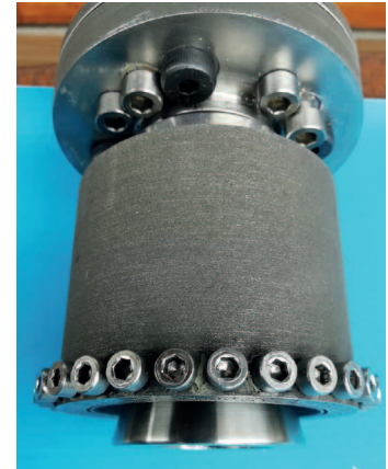
Bild 7: Konischer Dorn, der zur Einstellung des maximal möglichen Düsenspalts weit aus der Düse herausgeführt wurde
