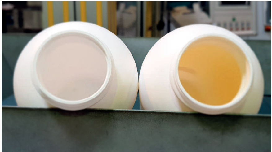
Die beiden Flaschen für die zweite Versuchsreihe bestehen komplett aus PCR. Die Flasche rechts wurde innen mit einer CHF-Beschichtung von Delta Engineering versehen (Alle Fotos: W. Müller)
