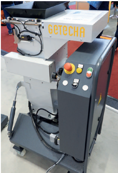
Die Sauberraum-Mühle GRS 180 von Getecha zeichnet sich unter anderem durch ihre platzsparende Niedrigbauweise aus
