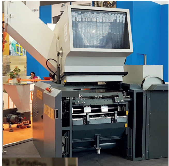
Die mächtige schallgeschützte Getecha-Zentralmühle 45090 ist ausgelegt für Durchsätze von bis zu 900 kg/h (Alle Bilder: Getecha)
