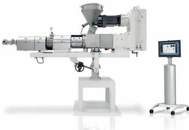
Konischer Doppelschneckenextruder KMD 73 K/P als Säulenversion ausgeführt
