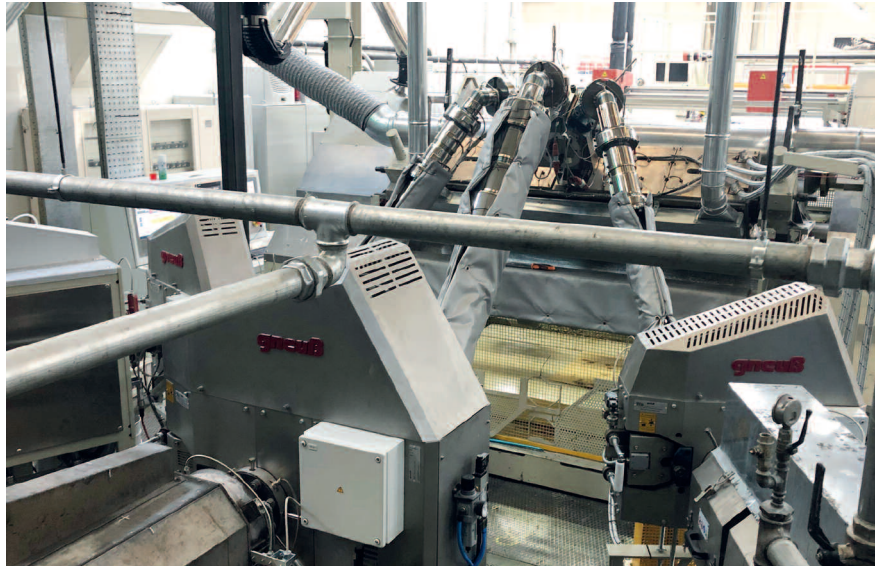
Plattenextrusionslinie bei MP3 mit drei druck- und prozesskonstanten Gneuss SFXmagnus Schmelzefiltern
