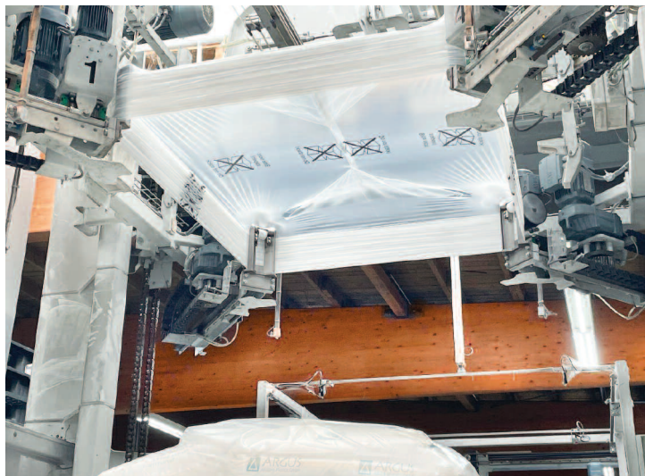
Hält höchsten Belastungen Stand beim Kunden ARGUS Additive Plastics und ist mit 30 Prozent Rezyklat aus Haushalts- und Gewerbeabfällen hergestellt: Stretchhood von RKW aus Nordhorn
