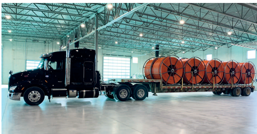
Eine der ersten Ladungen mit 3-lagigen HDPE-Rohr mit einer Silikon-Innenschicht vom Branchen-Newcomer Encoma in Kanada
