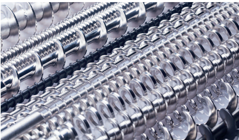
Schneckenvielfalt – die richtige Auswahl einer Dosierschnecke ist der Schlüssel zum präzisen Dosieren (Bild: motan-colortronic)
