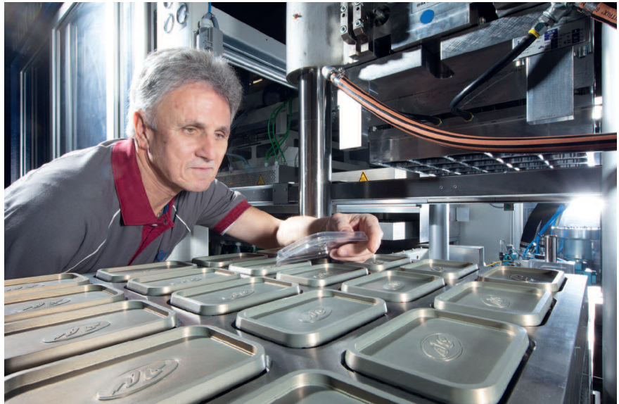
ILLIG vereint Maschinen- und Werkzeugbau unter einem Dach. Im Bild: Mehrfachwerkzeug für Deckel in einer Thermoformmaschine. (Foto: ILLIG)
