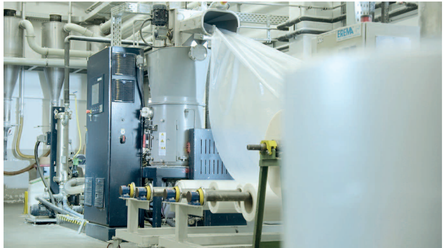
Die INTAREMA® K ist bei Coveris 24 Stunden pro Tag im Einsatz. Das recycelte Material wird zu 100 Prozent in die Folienproduktion rückgeführt (Fotocredits: EREMA)
