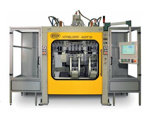
Die HYBLOW 407 D, mit der von BEKUM patentierten C-Rahmen-Schließeinheit, ermöglicht die prozesssichere Herstellung von EPET-IV-Flaschen mit Entbutzung und gerichteter Flaschenübergabe integriert in der Maschine (Alle Bilder: BEKUM)
