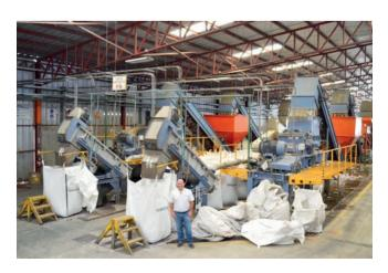
Nach der Sortierung werden die PET-Flaschen in zwei Herbold Schneidmühlen mit einer Leistung von je 1800 ka/h zerkleinert After sorting, the PET bottles are size reduced in two Herbold granulators each with a capacity of 1800 kg/h
