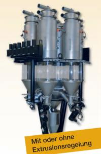
X-Serie: Kontinuierlicher gravimetrischer Mischer für bis zu 8 Komponenten
