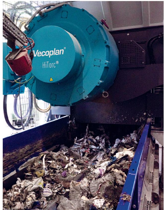
*Zerkleinerer bereiten gesammelte Verpackungen aus Kunststoff, Metall und Verbundmaterialien oder auch Hausmüll effizient auf. Eine wichtige Stellschraube ist dabei der Antrieb für den Rotor (Bilder: Vecoplan AG)*
