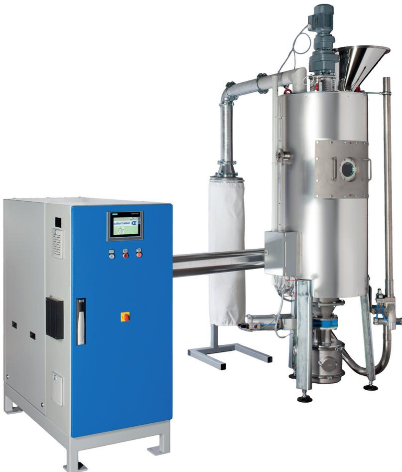
*Bei einem Festbett-Kristallisator wird in einem definierten Prozess eine erhitzte Luftmenge durch einen Rührwerkstrichter geleitet, um den gewünschten Kristallisationsgrad zu erreichen
