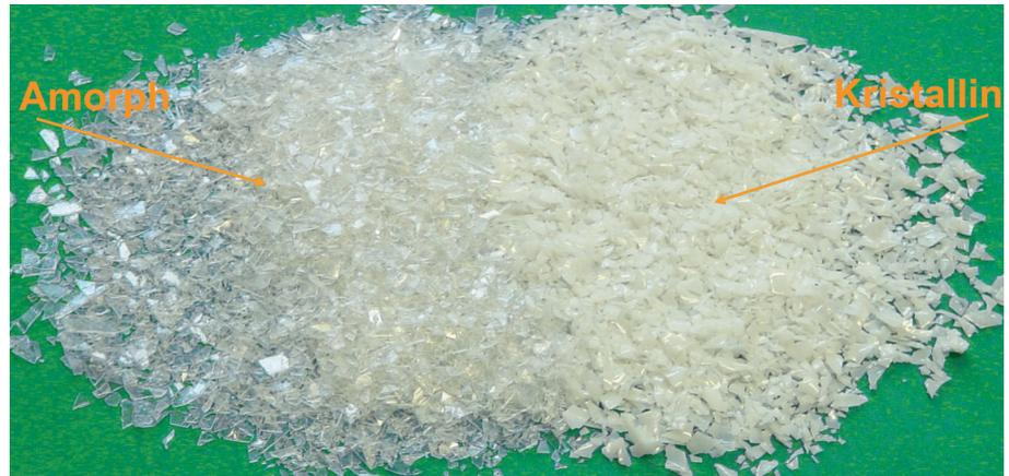
Wenn hierbei die Rede von „kristallisiert“ ist, bedeutet dies in der Regel „teilkristallisiert“. Der maximal erreichbare Kristallisationsgrad zum Beispiel für PET liegt bei circa 75 Prozent mit einer Dichte von 1,420 g/cm<sup>3</sup>. Die Dichte steigt linear mit dem Kristallisationsgrad. An der Verklebungsgrenze bei einem Kristallisationsgrad von circa 11 Prozent ist die Dichte circa 1,345g/cm<sup>3</sup>. Amorphes PET hat eine Dichte von circa 1,335g/cm<sup>3</sup>.
