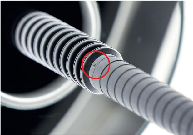
**50** Mit dem neuen Inline-System ProfilControl 7 S CorrugatedTube von PIXARGUS lässt sich die Ringstruktur von Wellrohren jetzt lückenlos prüfen.
