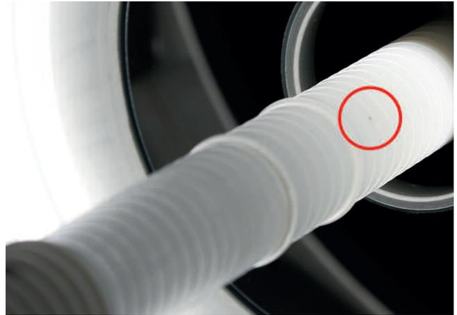
*Was für das menschliche Auge kaum sichtbar ist, findet ProfilControl 7 S CorrugatedTube in Sekundenschnelle: Kleinste Fehler wie Löcher, Dellen, Blasen, Knoten, Kratzer, Risse oder mangelhafte Quetschnähte werden von dem System zu 100 Prozent erkannt*
