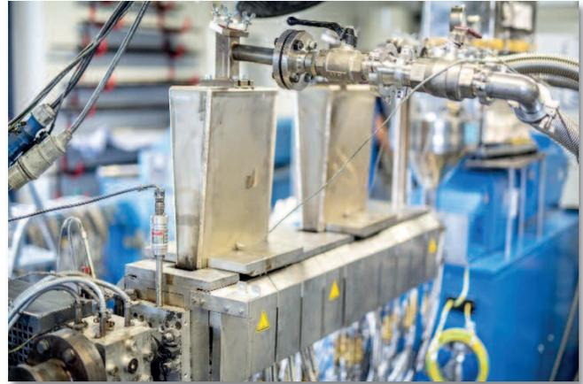
Hier erfolgt im zweiten Schritt die thermische Aufspaltung der zerkleinerten Polystyrol-Abfälle in Monomere und Oligomere sowie flüchtige Spaltprodukte. Während in den aktuellen Untersuchungen bei Einsatz von Neuware-PS Kondensatausbeuten von rund 65 Prozent erzielt werden, sind es bei der PS-Fraktion aus dem Gelben Sack nur rund 40 Prozent. Gründe dafür sind Füllstoffe, Fremdpolymere und Schmutzanhaftungen, die das Polymer verunreinigen.
