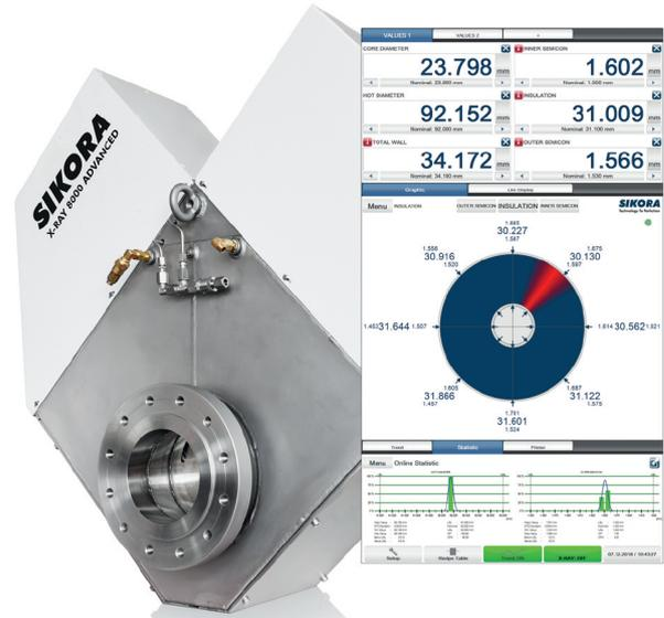
Die Messwerte des X-RAY 8000 ADVANCED werden übersichtlich am Monitor des dazugehörigen Prozessorsystems dargestellt
