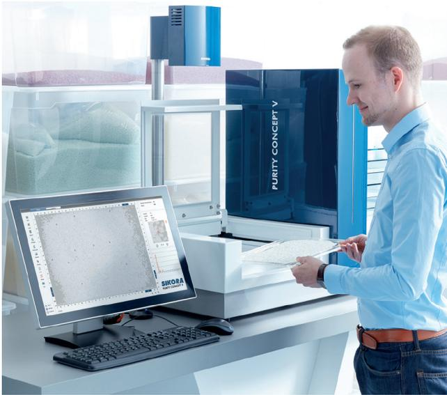
Das PURITY CONCEPT V wird zur optischen Stichprobeninspektion von Kunststoffgranulat eingesetzt. Detektiert werden unter anderem Black Specks
