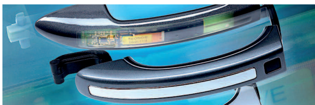
Bild 2: Beispiel eines Türgriffmoduls mit integrierter Sende-/Empfangelektronik zur Realisierung eines schlüssellosen Zugangs (Foto: WITTE Automotive)
