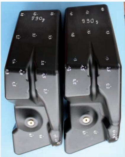
**Bild 2:** Gewichtsreduktion von über 20 Prozent, die durch eine Optimierung der Wanddickenverteilung erreicht wurde
