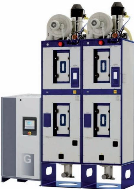
Das CARD R-System, eine Kombination aus Trocknungsbehälter und Druckluftkompressor mit Wärmetauscher, gewinnt die Wärme, die Druckluft als Nebenprodukt liefert und die üblicherweise an die Umwelt abgegeben wird, zurück und nutzt sie zum Vorheizen im Prozess- beziehungsweise Sekundärkreislauf
