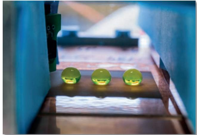
In der Vereisungskammer testen Fraunhofer-Wissenschaftler, wie sich die Anti-Eis-Beschichtung auf das Gefrierverhalten von Wassertropfen auswirkt (© Foto Fraunhofer IGB)
