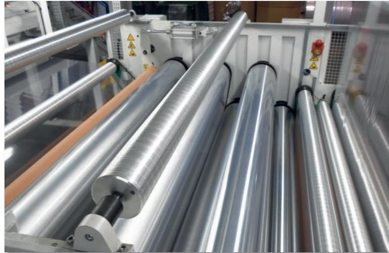
**Temperwerk MIDEX-UF:** Mit dem optionalen Temperwerk kann auch bei dicken Folien und asymmetrischen Verbunden ein hervorragendes Curling erzielt und das Schrumpfverhalten der Folie optimiert werden
