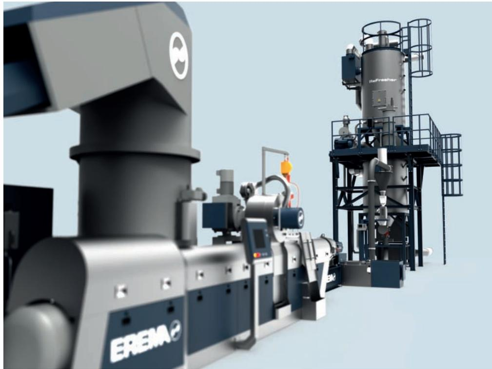
*Die Kombination von ReFresher und der bewährten TVEplus-Technologie bietet selbst bei stark verschmutzten Verpackungsabfällen erstmals geruchsneutrale Rezyklate (Bilder: EREMA)*
