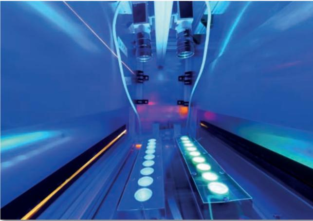
Optisches Messsystem zur Inline-Kontrolle von Schichtdicke und Vernetzung organischer Beschichtungen
