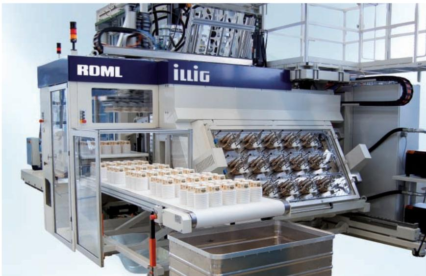
Inmold Labeling zur markenwirksamen Dekoration mit hoher Regalwirkung: Mit dem Formautomat ILLIG IC-RDML 70b und einem 18-fach-Werkzeug entstehen in einem Arbeitsgang brillant dekorierte Verpackungen aus PP
