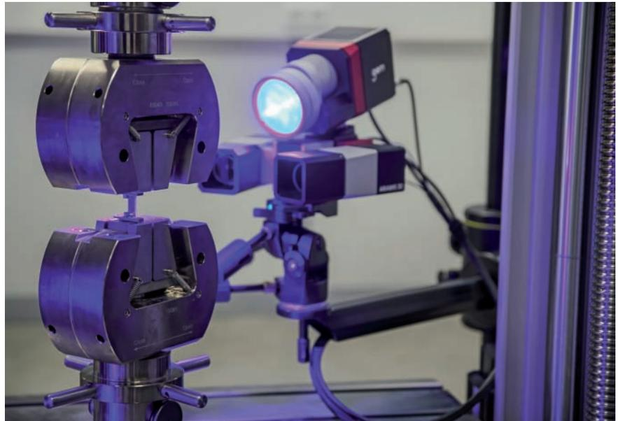
Zu den angebotenen Leistungen gehört unter anderem die Durchführung von Versuchen zur mechanischen Werkstoffprüfung einschließlich quasi-statischer sowie dynamischer Kennwertermittlung (Alle Bilder, Quelle: ARRK Engineering)
