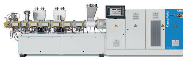
Optimal an den Prozess angepasster Zweischneckenextruder ZE 42 Blue Power hält die Vernetzung im Extruder unter Kontrolle
