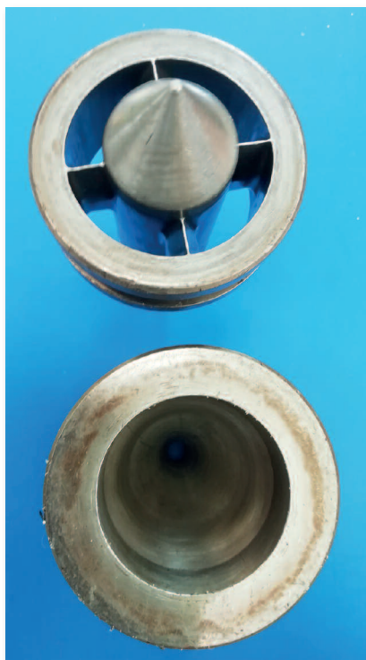
Bild 2: Düse (unten) und Stegdornhalter (oben) eines konventionell gefertigten Kopfs zur Herstellung von Mehrlumenschläuchen
