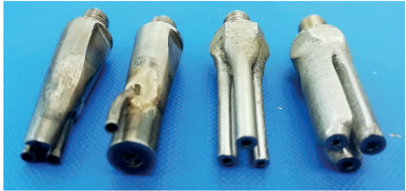
Bild 3: Zwei konventionell gefertigte Dornendstücke (links) und zwei im SLM-Verfahren hergestellte strömungsgünstig gestaltete Dornendstücke (rechts)
