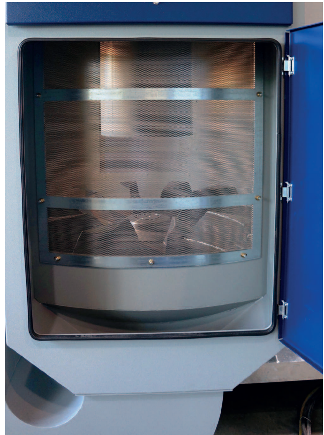
Bild 5: Blick durch ein Tangentialsieb in die Zentrifugenkammer des DRD 26-Systems, unten das Doppel-Rotorsystem mit 12 Rotorflügeln, darüber das Heizregister-Gehäuse (Bild: Reinhard Bauer)
