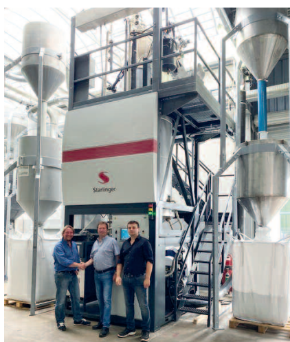
Der neue SSP (Solid State Polykondensation SSP1800) der Firma Starlinger, von links: Christian Lovranich, Starlinger & Co. GmbH, mit Richard Wüllner und Andrzej Zajontz, Geschäftsführer der BTB PET-Recycling GmbH & Co. KG (Foto: BTB PET-Recycling)
