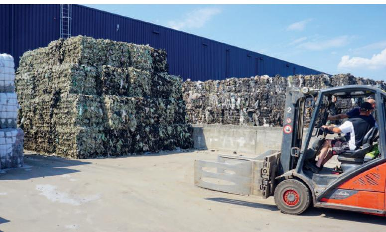
Bild 3: Die Folienballen werden bei DALY Plastics aufgelöst. Anschließend durchlaufen sie einen Sortierprozess, in dem Fremdmaterial ausgeschieden wird und die Folien nach Farbklassen oder Materialqualität getrennt werden. Daraus werden sortenreine Ballen hergestellt, die in der Recycling-Anlage zu Granulat verarbeitet werden
