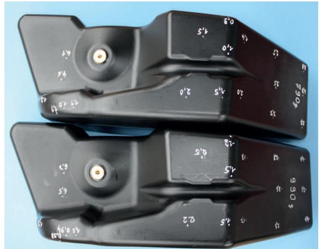
**Bild 3: Scheibenwaschwasserbehälter für einen Geländewagen**
