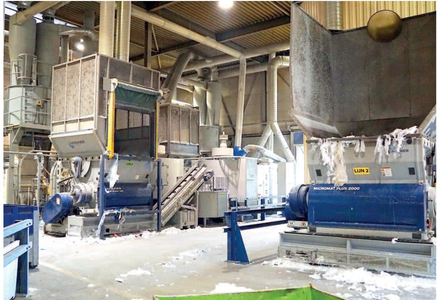
*Bild 4: Die sortenreinen Folienballen werden in Schneidmühlen zu Folienflakes verarbeitet und anschließend direkt chargenweise MAS-DRD-Trockenreinigern zugeführt, wo körnige Verschmutzungen und Feuchtigkeit entfernt werden*
