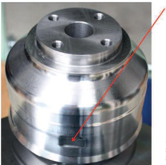
Bild 2: Um die geforderte Wanddicke von 1 mm am Beginn des Einfüllgewindes des Kanisters zu erreichen, muss man mit einem konisch gestalteten Fließkanal die Wanddicke über den gesamte Umfang und über die Länge des Einfüllstutzens extrem vergrößern
