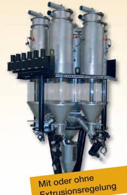
**X-Serie:** Kontinuierlicher gravimetrischer Mischer für bis zu 8 Komponenten
