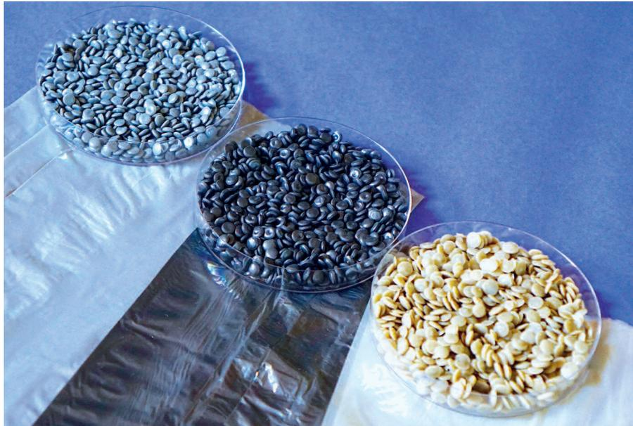
Bild 1: Der niederländische Kunststoff-Recycler DALY Plastics verarbeitet rund 35.000 Tonnen Agrarfolien, sowie Paletten Schrumpffolien pro Jahr zu grauen, schwarzen und teefarbenen Polyäthylen-Regnulat für die Wiederverwendung in der Blasfolien-Herstellung (Alle Fotos: TECHNOKOMM)
