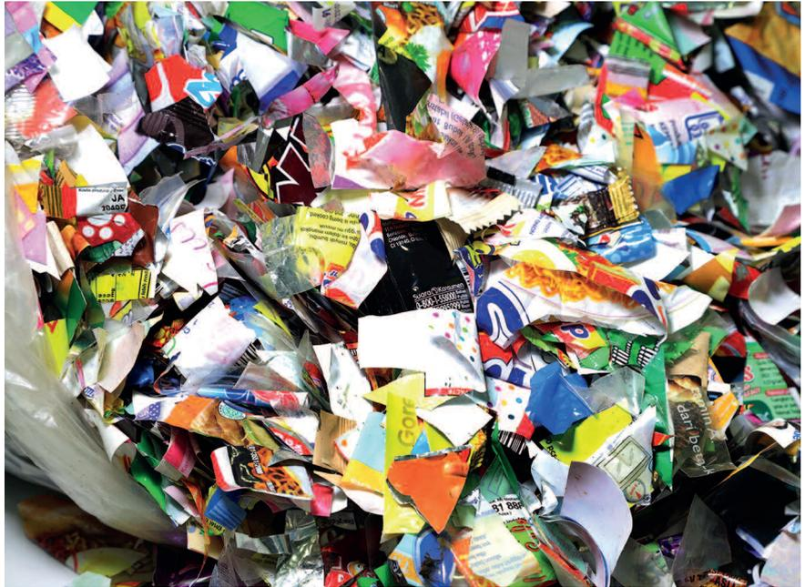
Verpackungen bestehen typischerweise aus Mehrschichtlaminatfolien, wodurch das Recycling zu hochwertigen und reinen Polymeren bislang nicht möglich war (Bilder © Fraunhofer IVV)
