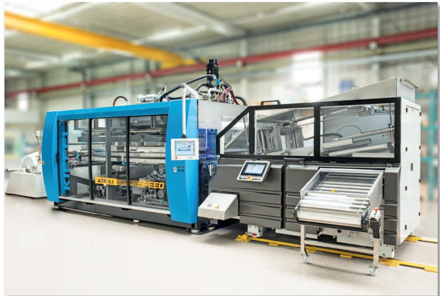
Becherformanlage Thermorunner KTR 5.1 Speed mit PUS Stapelgerät
