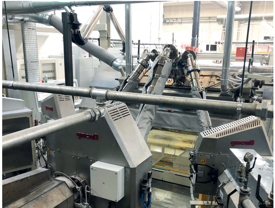
MP3的片材挤出生产线，具有三个压力和工艺恒定的Gneuss SFXmagnus熔体过滤器
