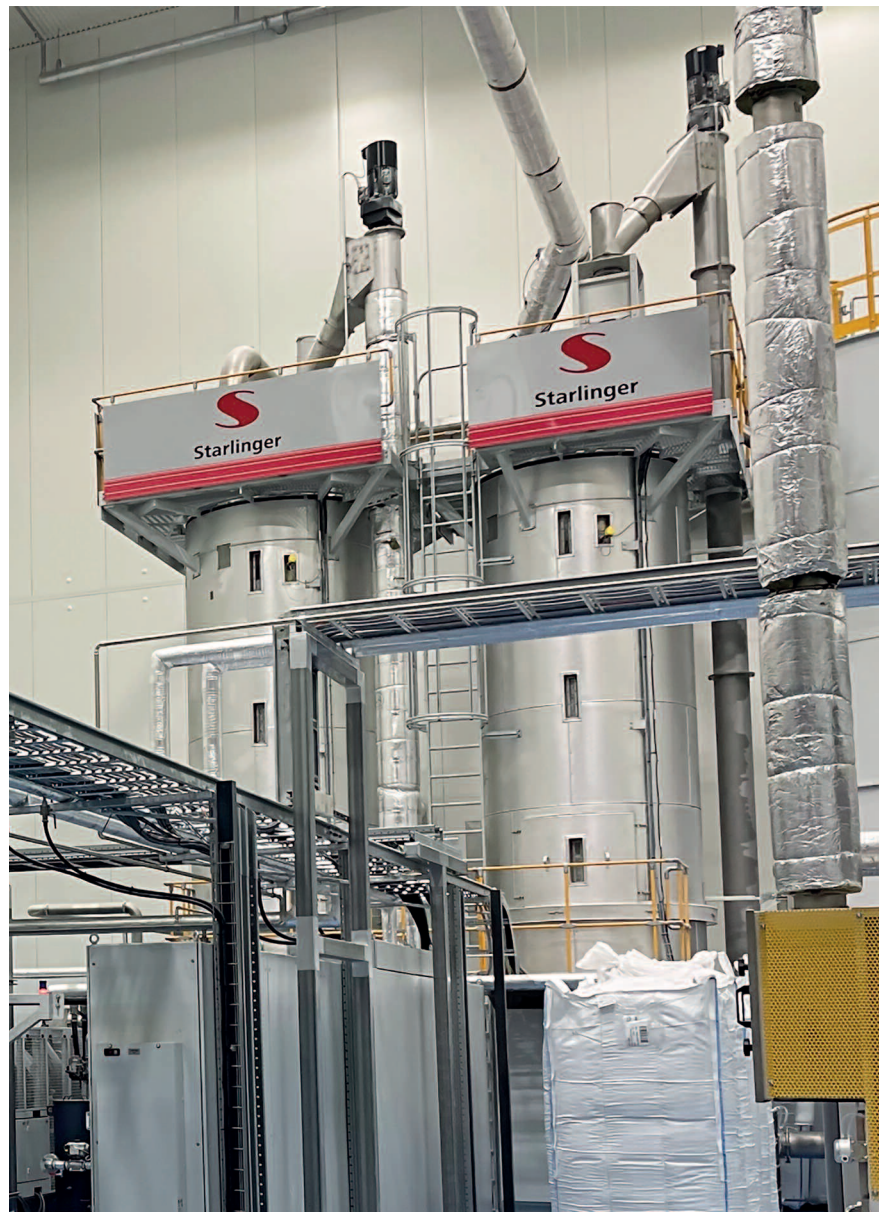
viscoSTAR SSP反应器中的真空处理用于IV增加和去污，使回收的PET可安全用于食品接触包装 (©CPA)
